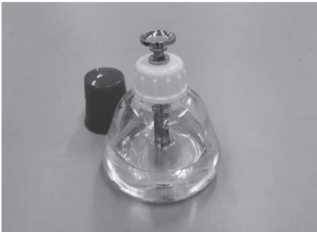
図1 定量液吐出容器(ハンドラップ®) 上部の受皿部分を押すことにより、ガラス容器内の液体をサイフォンの働きにより上部へ吐出させることができる。
