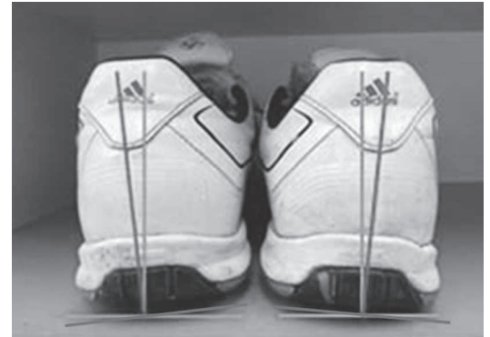
Fig.2 靴の踵内外側の片減りの計測
